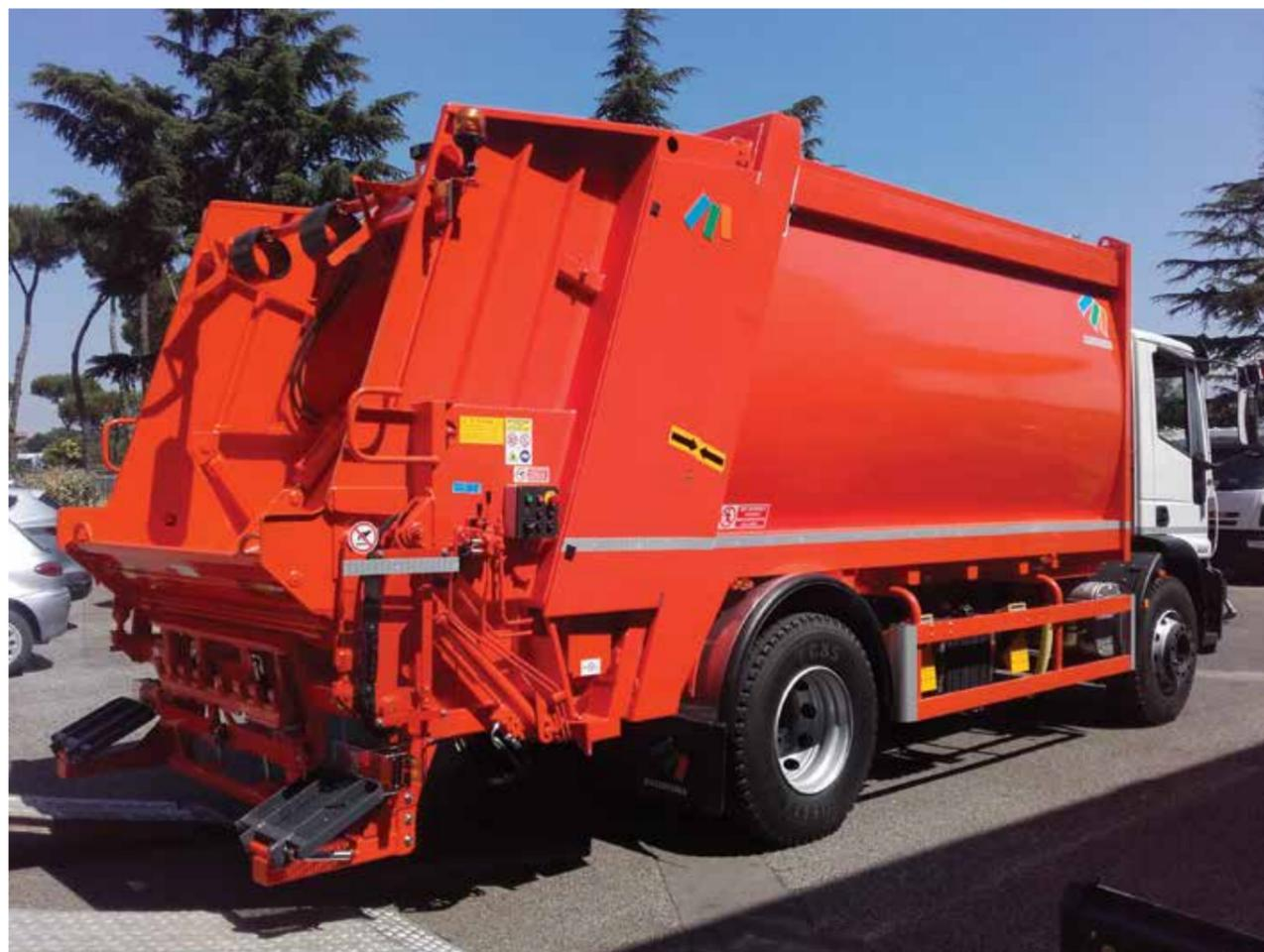
Для обеспечения высокого коэффициента сжатия и прочности конструкции используется запатентованная система уплотнения MAC, где плита перемещается по двум направляющим сверху и снизу, а гидроцилиндры выполнены из закаленных и хромированных материалов. Все элементы системы расположены вне загрузочного кузова, что предотвращает загрязнение и обеспечивает быстрый доступ для обслуживания и диагностики.
