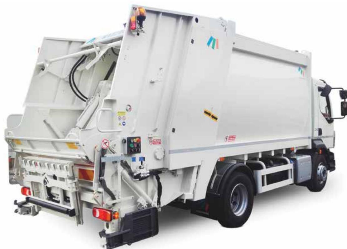
Выгрузка отходов осуществляется выталкивающей плитой с гидравлической регулировкой мощности давления. Усовершенствованный электронный контроль гидравлической системы (с возможностью передачи данных) гарантирует безопасность и безупречную функциональность оборудования в соответствии с самыми высокими стандартами. Цилиндры, приводящие в действие выталкивающую плиту, сделаны из высокопрочной стали и расположены таким образом, что не мешают движению мусора.
