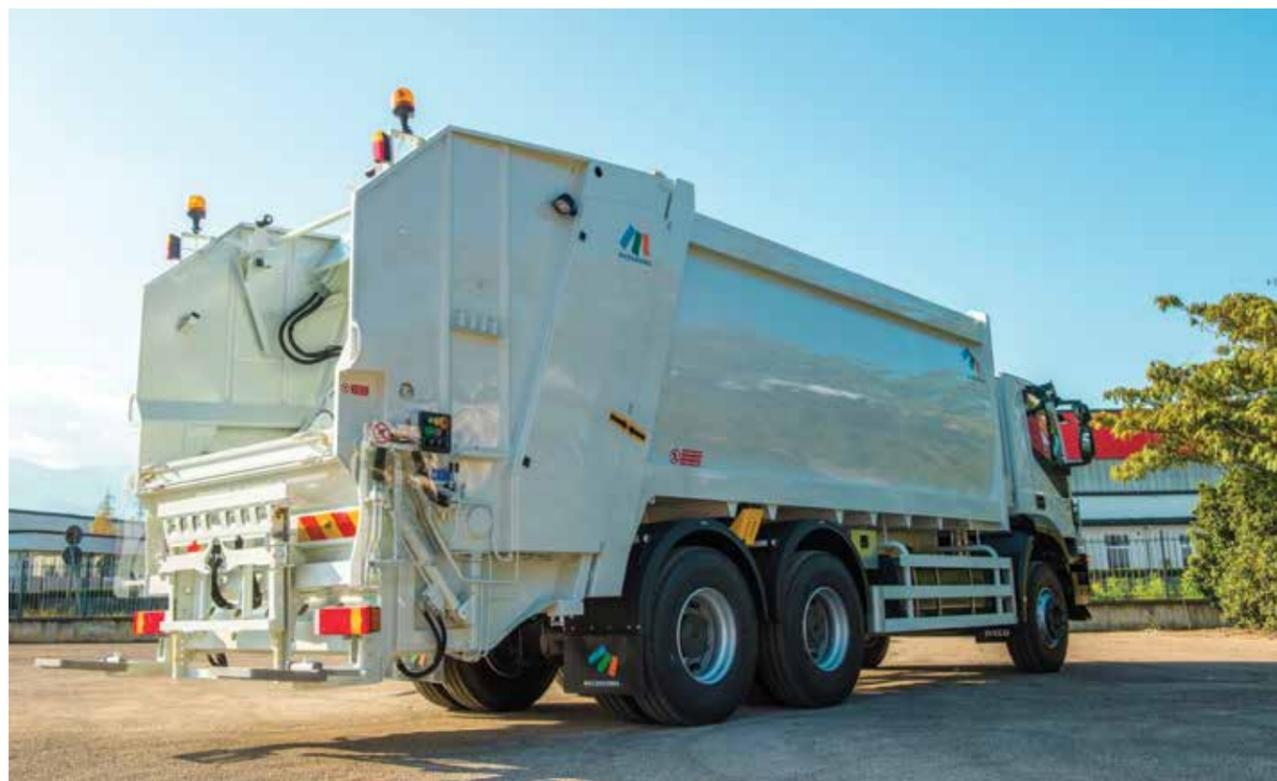
Все элементы системы расположены вне загрузочного кузова, что предотвращает загрязнение и обеспечивает быстрый доступ для обслуживания и диагностики. Выгрузка отходов осуществляется внутренней выталкивающей плитой с гидравлической регулировкой мощности давления. Усовершенствованный электронный контроль гидравлической системы (с возможностью передачи данных) гарантирует безопасность и безупречную функциональность оборудования в соответствии с самыми высокими стандартами.
