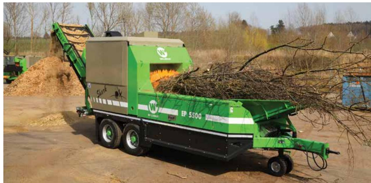
Отходы измельчаются мощным ротором, состоящим из наваренных дисков, между которыми свободно вращающиеся ножи, закрепленные на специальных шарнирных держателях. Ножи дробят материал против стационарно закрепленного на стенке гребня.
