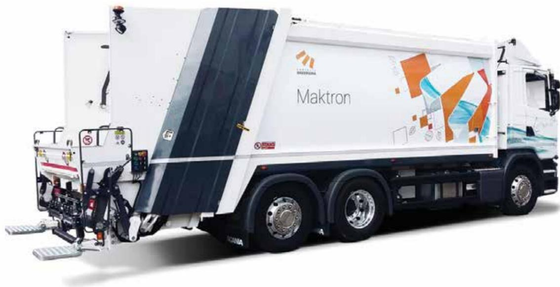
Система уплотнения располагается в приемном бункере, что улучшает распределение веса. Новая система сочлененной плиты имеет оптимизированную кинематическую цепь для уплотнения отходов крупного размера. Несущая плита перемещается по двум направляющим, которые находятся снаружи кузова и гарантируют легкий доступ для чистки и обслуживания.
