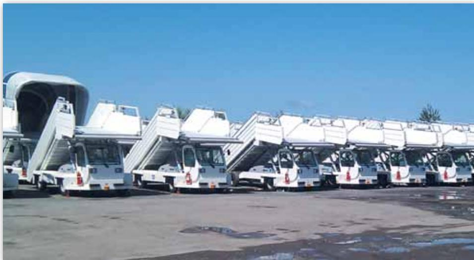
садки позволяет избежать повреждений двери ВС. При погрузке датчик отслеживает уровень просадки ВС. В случае если ВС начинает просаживаться от загруженного багажа, груза и большого числа пассажиров, датчик дает электрический сигнал на гидроцилиндры. Благодаря опусканию платформы дверь ВС не может быть повреждена.
