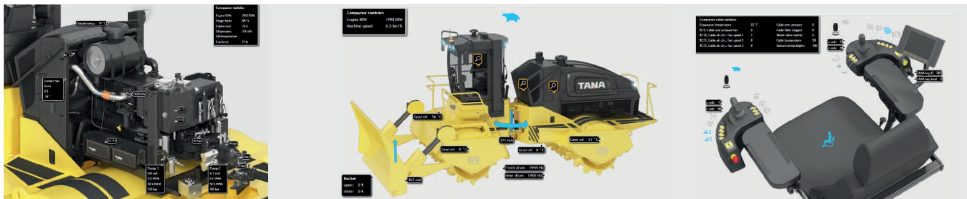
Система TANA SMART SITE™ предлагает инструмент для обзора статуса уплотнителя и подробных сведений о силовом блоке через сеть Интернет в реальном времени.
