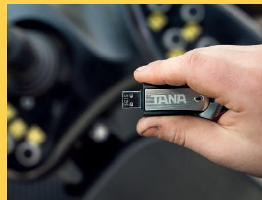
Ключ, специально назначенный для оператора компанией TANA, позволяет накапливать данные о работе в системе TANA SMART SITE™. Каждый ключ можно зарегистрировать на определенного оператора.
