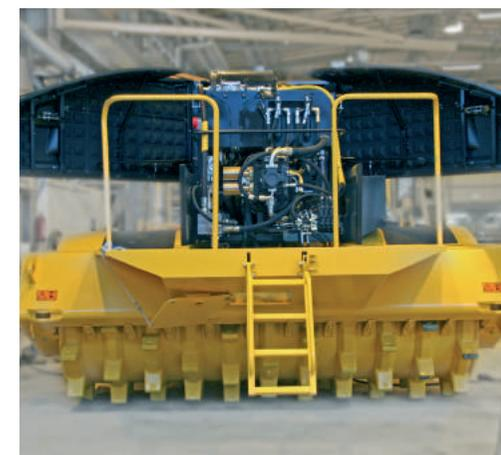
Простота конструкции обеспечивает высокую продолжительность безотказной работы уплотнителей TANA. Легкий доступ к блоку питания в задней части экономит время во время проведения регулярных работ по техническому обслуживанию и проверок. Дополнительные лестницы упрощают ежедневный рабочий процесс эксплуатации машины.
