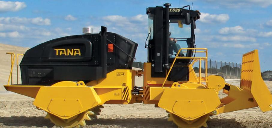
**Жесткая рама TANA позволяет распределять вес равномерно по всей рабочей ширине на неровной поверхности**
