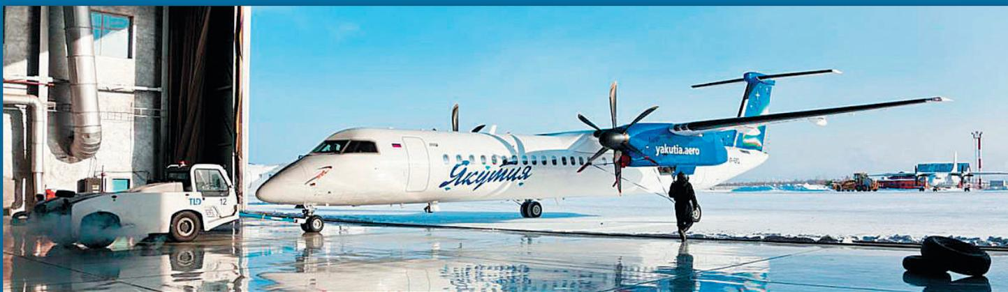
Фото 1. Тягач ТМХ-150 во время буксировки ВС типа DASH-8 в аэропорту Якутск
