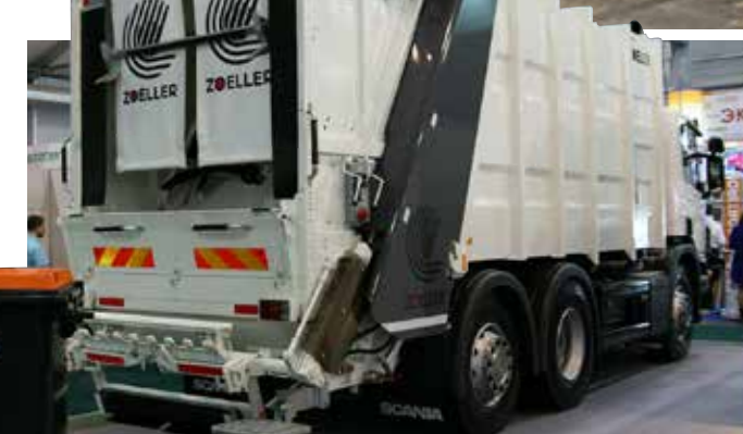
Мусоровоз Zoeller Medium XL-S на шасси Scania P310
