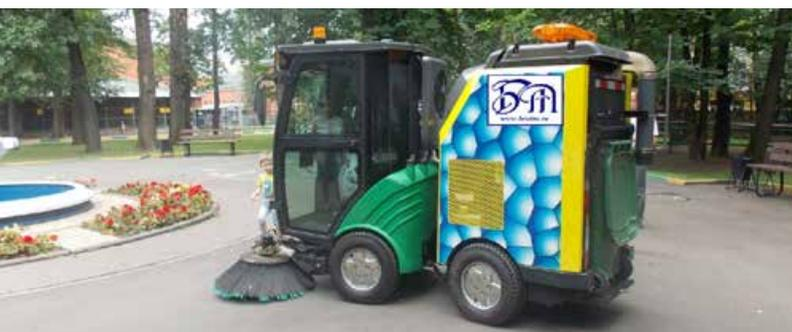
звуковой аварийный сигнал и световой сигнал включения стояночного тормоза. У современных подметальных машин есть кнопка аварийной остановки, аварийный рычаг бункера и система пылеподавления, которая распыляет водяной туман над боковыми щетками, осаждающий пыль, – эта функция особенно полезна при работе в помещениях.
