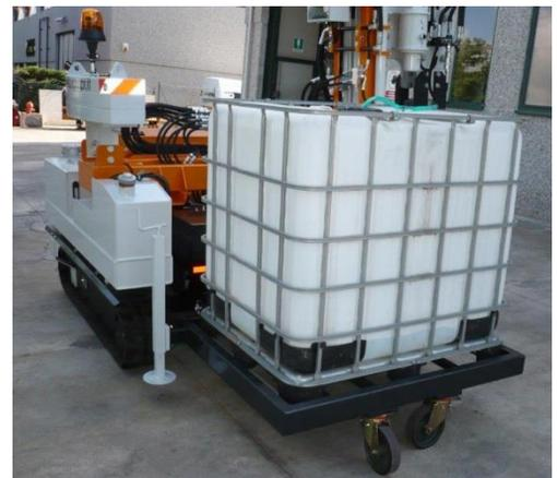
**Большой гидравлический бур** – простота работы и управления сверлением делают его незаменимым для бурения бетона. Идеально подходит для kernового бурения с высокой точностью и скоростью. Ручная регулировка скорости позволяет оператору полностью контролировать бурение, имея возможность учитывать твердость материала и диаметр отверстия (от 70 до 250 мм).
