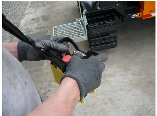
**Вакуумная система пылеподавления** – предлагает решение для борьбы с пылью. Полностью пневматическая система может быть использована при сверлении бетона. Это позволяет сократить выброс пыли, которая образуется во время сверления.
