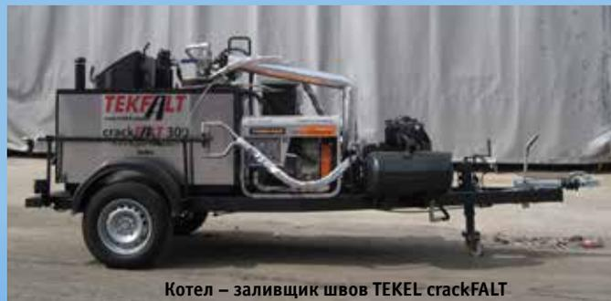
Котел – заливщик швов TEKEL crackFALT
