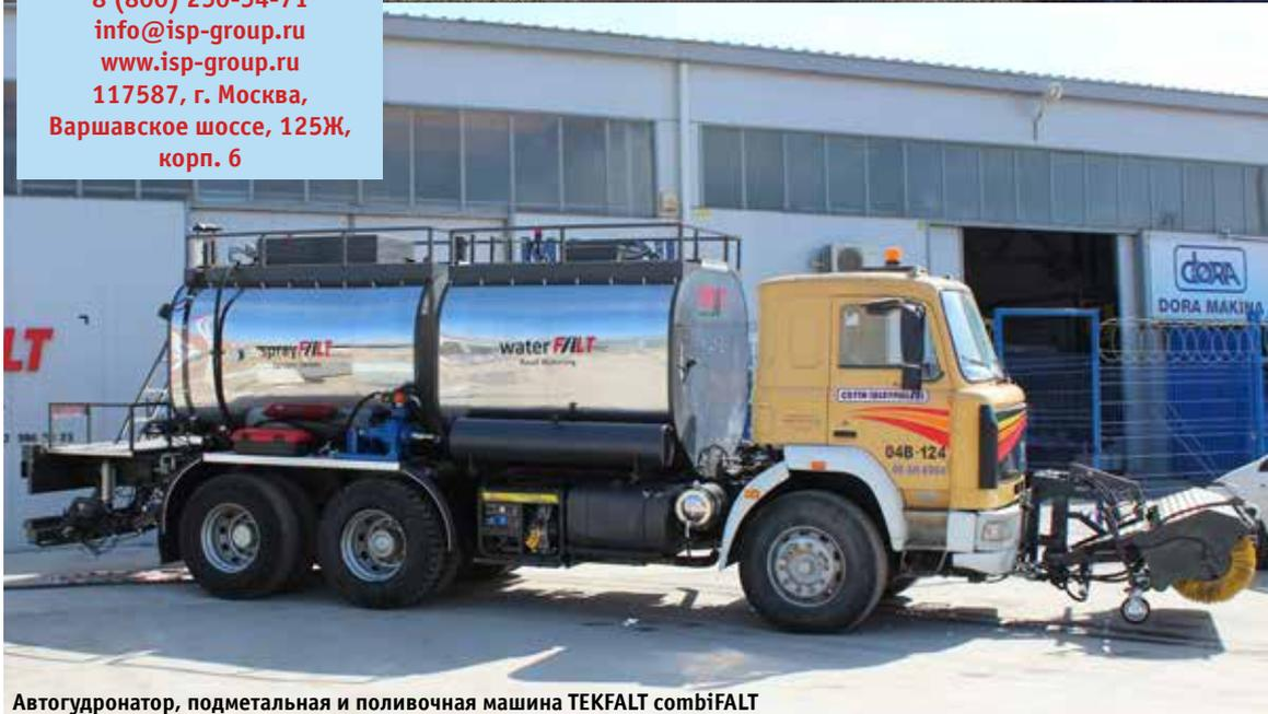
Автогудронатор, подметальная и поливочная машина TEKFALT combiFALT
